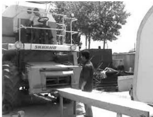
شکل 3- نحوه ی قرارگیری تسمه نقاله در جلوی کمباین
