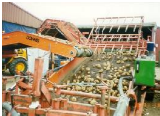
شکل 1- تسمه نقاله زنجیری کمباین و طرح‌واره اتصال مبدل یکسر درگیر به چرخ زنجیر دوم کمباین برداشت
