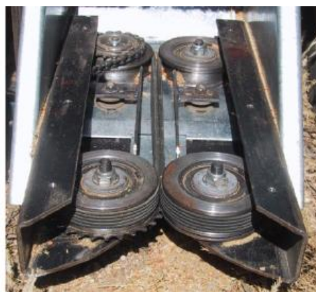
شکل ۵- مکانیزم تسمه و پولی برداشت عدس
